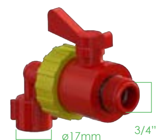
4778 Rubinetto a sfera 3/4" con uscita 90° per tubo ø12 x17mm con ghiera
