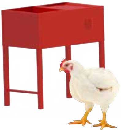
264601026 Spennapoli 220V - 50Hz - 0,5HP - 24 dita Prima dell'utilizzo, immergere l'animale in acqua calda (55°C) Produttività: 80 polli/ora, motore monofase
